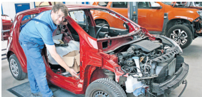
Kapitaler Unfallschaden: Karosseriebaumeister Sascha Engel zeigt ein Fahrzeug, bei dem die gesamte A-Säule neu eingeschweißt werden musste. Fotos: tha
