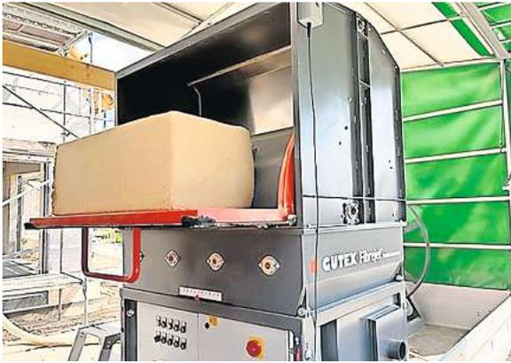
Ohne großen Aufwand kann die mobile Einblasmaschine zur Baustelle transportiert werden, um Zellulose- oder Holzfaserdämmung zu verarbeiten.
