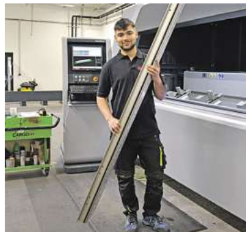
Mit der computergesteuerten Maschine kann John Gremmes Aluminiumfensterprofile bearbeiten.
